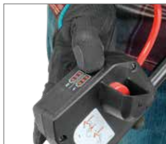
Indikace stavu akumulátorů
