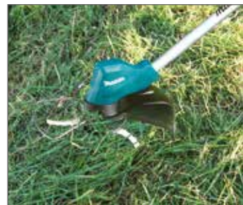
Zpětný chod pro očištění nástroje
