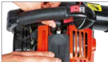
Jednoduchá výměna svíčky
